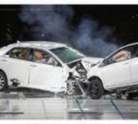
**Figura 2.1** Los fabricantes de automóviles realizan pruebas de choque controladas. Estas pruebas consisten en estrellar vehículos contra muros de concreto, o bien, provocar choques entre vehículos de prueba. Las colisiones son estudiadas utilizando cámaras e instrumentos de medición capaces de registrar diferentes magnitudes, como la distancia y el tiempo transcurrido.
