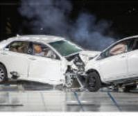
**Figura 2.1** Los fabricantes de automóviles realizan pruebas de choque controladas. Estas pruebas consisten en estrellar vehículos contra muros de concreto, o bien, provocar choques entre vehículos de prueba. Las colisiones son estudiadas utilizando cámaras e instrumentos de medición capaces de registrar diferentes magnitudes, como la distancia y el tiempo transcurrido.
